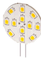
G4, 170 LUMEN, 2,2 WATT, STRALINGSHOEK <180°. IDEAAL VOOR DEZE ONDERBOUWVERLICHTING.
