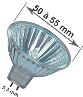
GU5.3 (OF MR16) LET OP, BESTAAT IN 12V EN 230V. AFSTAND TUSSEN PINNEN IS 5,3 MM.
